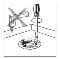
5) Die Schrauben gleichmäßig anziehen. Bitte keinen Akkuschrauber verwenden.
