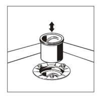
6) Das Tauchrohr in den Geruchsverschluss einsetzen.
