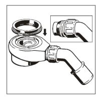
2) Die Doppeldichtung auf die Dichtfläche legen und in die Haltenut eindrücken.
