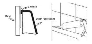
6) Zum Abdichten des Duschrandes und der Revisionsöffnung sollte Silikon verwendet werden.
