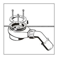
3) Den Ablaufkörper mit Dichtung unter der Duschwanne positionieren. Den oberen Teil der Doppeldichtung dann durch das Ablaufloch führen.
