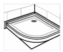
Jetzt kann der Umriss des Trägers auf dem Boden gekennzeichnet und die Platzierung des Ablaufs sowie der Verlauf der Rohre bestimmt werden.
