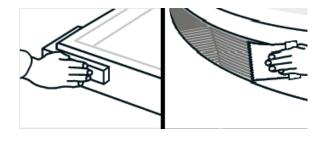
5) Vor dem endgültigen Einsetzen der Duschwanne, wird auf den vormarkierten Differenzstellen (in den Hohlraum zwischen dem Duschen- und Trägerboden und auf dem Duschrand) 2K Montageschaum aufgebracht. Dann kann der Träger für das Verfliesen verspachtelt werden.
